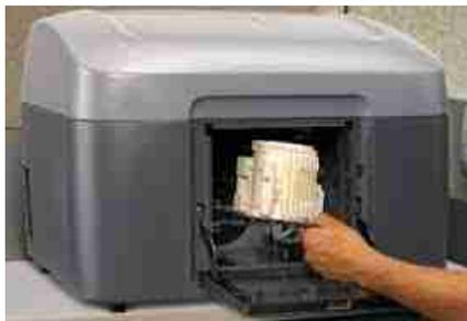
Máquina de estereolitografía
